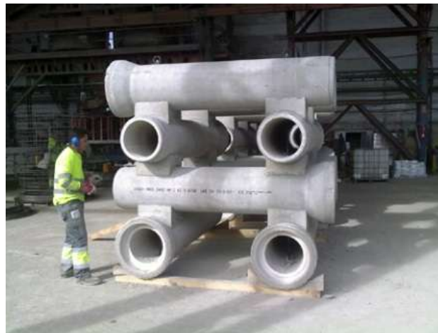
Figura 10. Módulo de tubo de hormigón con fines de producción
