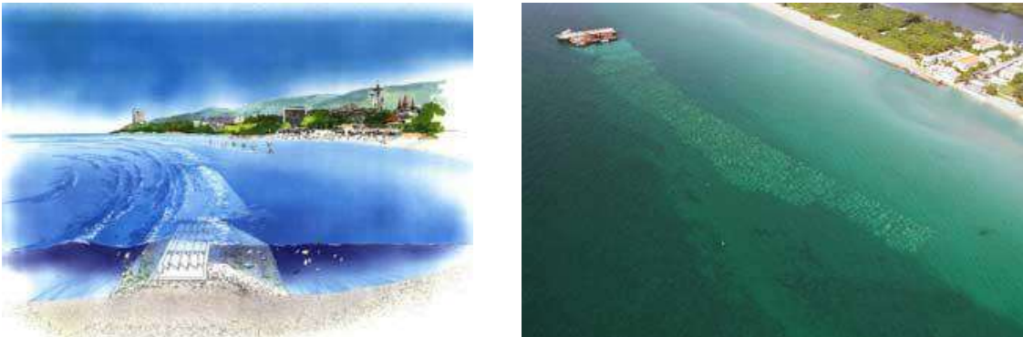
Figura 27. Protección de la línea de costa frente al oleaje mediante un arrecife artificial.
