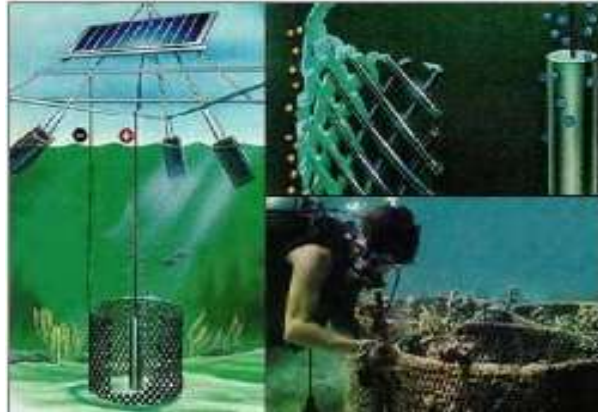
Figura 14. Esquema conceptual de arrecife por electrodeposición.
