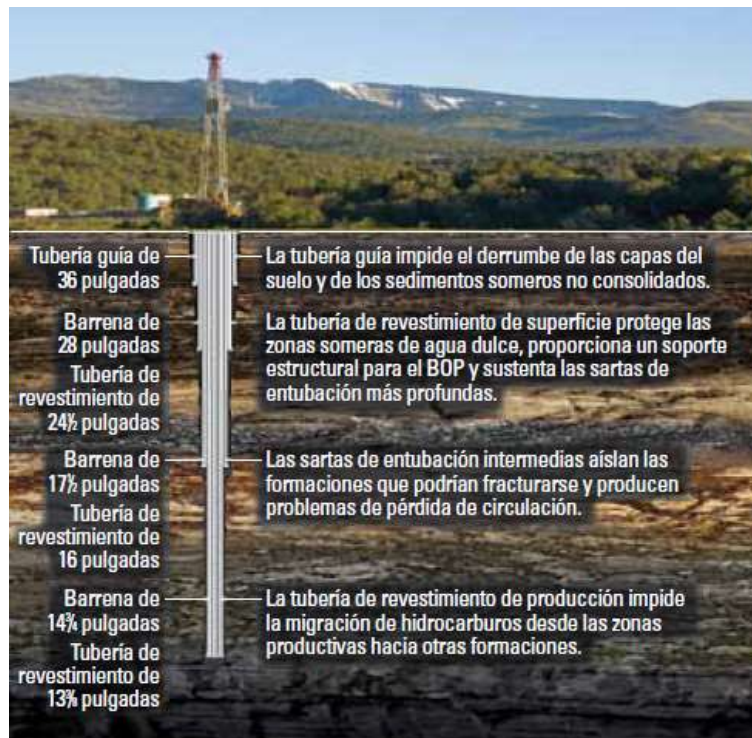
Figura 7. Revestimiento del pozo a diferentes profundidades (OGP, 2003)
