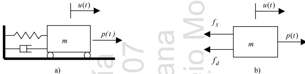
**Fig. 6.1** Modelo analógico de sistemas de un solo grado de libertad. **a)** componentes básicos **b)** Diagrama de cuerpo libre.
